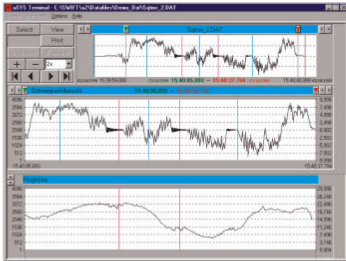
Bild 9: Sequentielle Extremas mit Zeit und Master/Slave-Funktion. Darstellung als Amplitudenverlauf mit Master- und Slave-Kanal
